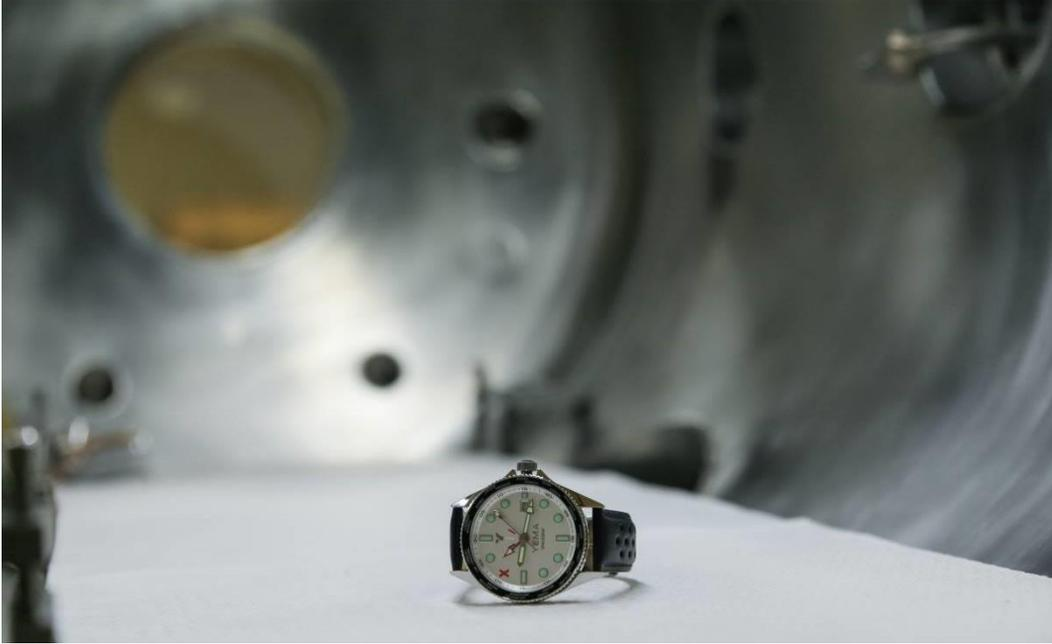
Figure 18 : Spacegraf après le passage au vide. © CNES/S. Rouquette
